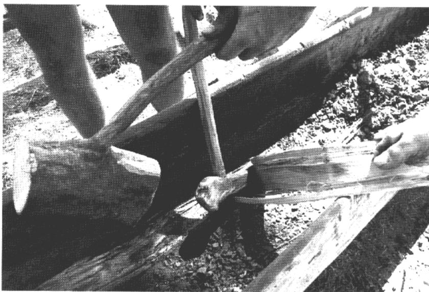
Fig. 8 : Evidage de la pirogue des Eyzies à la masse et au coin en bois de cerf (cliché : GRAS).
